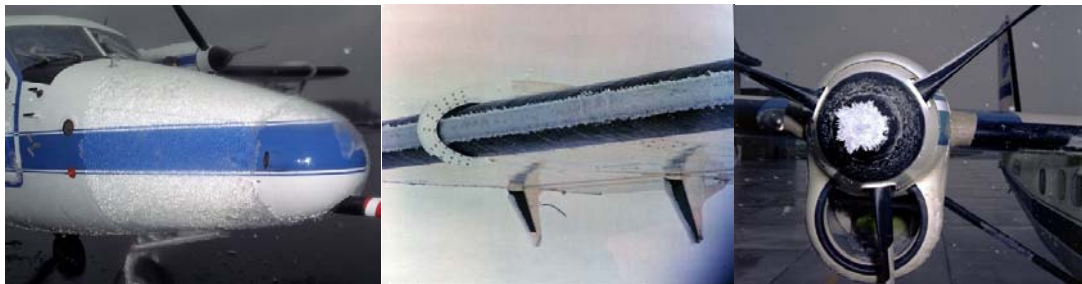
Fig.4.2-2 機首（左）翼（中）スピナー（右）への着氷（右） 4.2.3) - 4.2.5)
